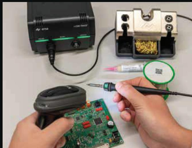
falsche Lötspitze in Relation zum Bauteil) werden vom System erkannt und an den Operator gemeldet. Sind alle Parameter korrekt, wird der Lötprozess freigegeben. Beim Löten erfasst die i-CON TRACE die Prozessdaten. Dadurch ist jeder Lötvorgang genauestens dokumentiert und rückverfolgbar.
