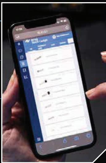
Jeder Lötstation lassen sich spezifische Lötaufgaben zentral zuweisen – via MES, PC oder Mobile Device. Dabei werden alle wesentlichen Parameter wie die zu verwendende Lötspitze, Temperatur, Lötdraht und Flussmittel zentral durch qualifiziertes Personal voreingestellt. Dadurch wird die Prozesssicherheit wesentlich erhöht: Jedes Werkstück wird gemäß den vorgegebenen Spezifikationen gelötet. Der Operator kann sich dabei ganz aufs Löten konzentrieren und die Fehleranfälligkeit sinkt.
